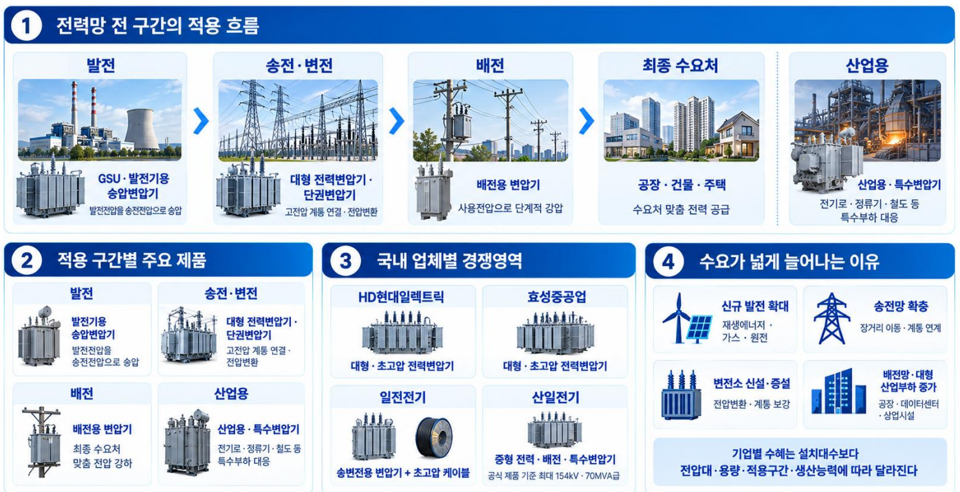
[그림 21] 전력망 전 구간에서 반복적으로 사용되는 변압기
