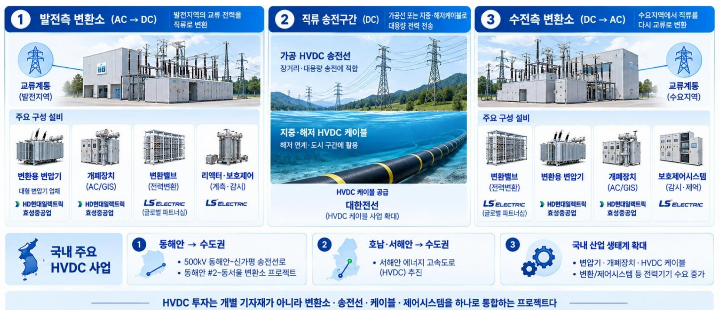
[그림 27] HVDC를 구성하는 핵심 전력기기와 송전구조
